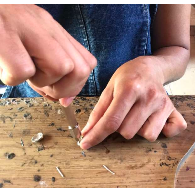
Marcar con una broca, el lugar donde estará el perno.
