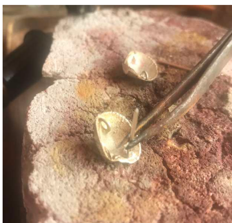
Sostener el perno con una pinza de presión inversa.
