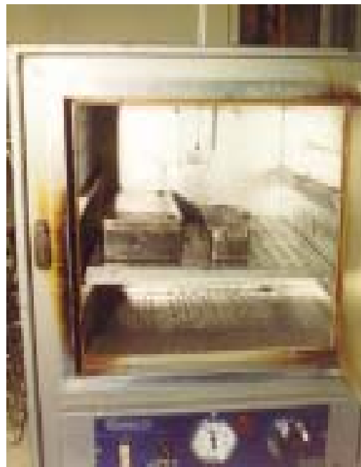
Disposição do material dentro da estufa mostrando o termômetro de bulbo
