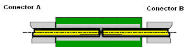
Figura 7 - Emenda por conectorização
