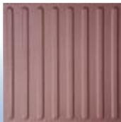
Do tipo cimentício, na cor amarela, medindo 0,25 m x 0,25m e 0,025m de espessura mínima, este piso deve ser utilizado como guia de caminhada orientador do deficiente visual, quando obrigatório na faixa acessível definida nesta cartilha, e excepcionalmente em rotas preferenciais de circulação, determinadas pelo município.
