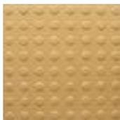
Do tipo cimentício, na cor amarela, medindo 0,25 m x 0,25m e 0,025 m de espessura mínima, este piso deve ser utilizado para alertar o deficiente visual, principalmente, para situações que envolvem risco de segurança.
