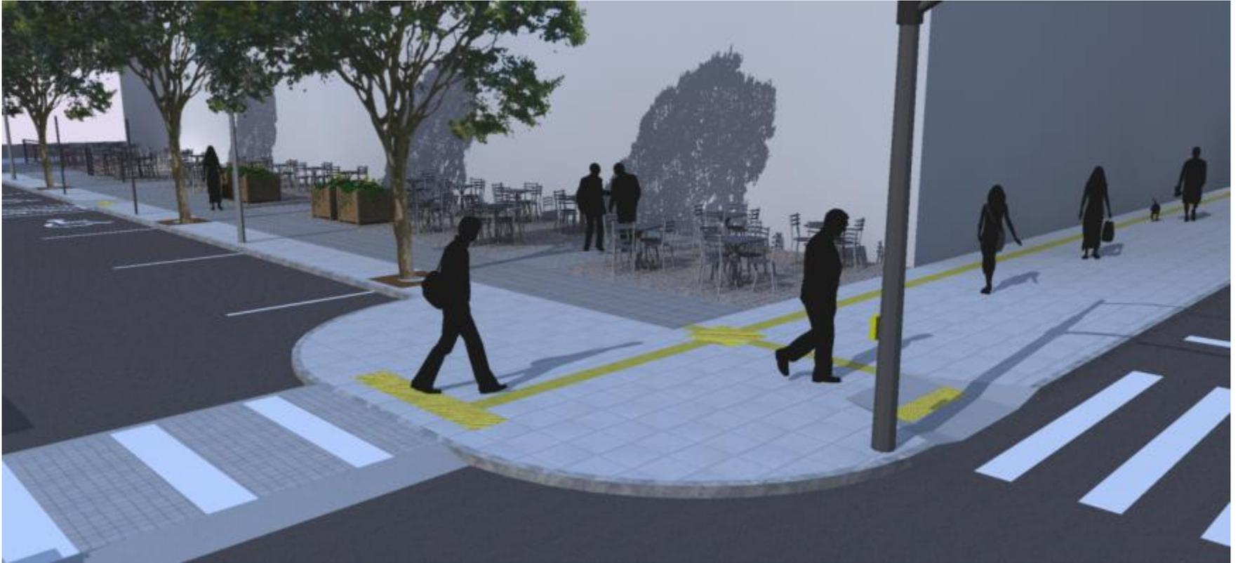
Esquina com aplicação de travessia em nível com a calçada e em nível com a faixa de rolamento.
