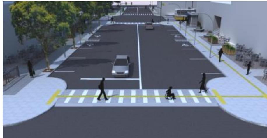
O rebaixo de calçada sob a forma de rampa, destinado a facilitar o trânsito de pessoas com deficiência física, é obrigatório junto às esquinas. A faixa acessível com ou sem o uso do piso tátil direcional, deve estar interligada aos rebaixos de calçada e as travessias em nível sobre a via.
