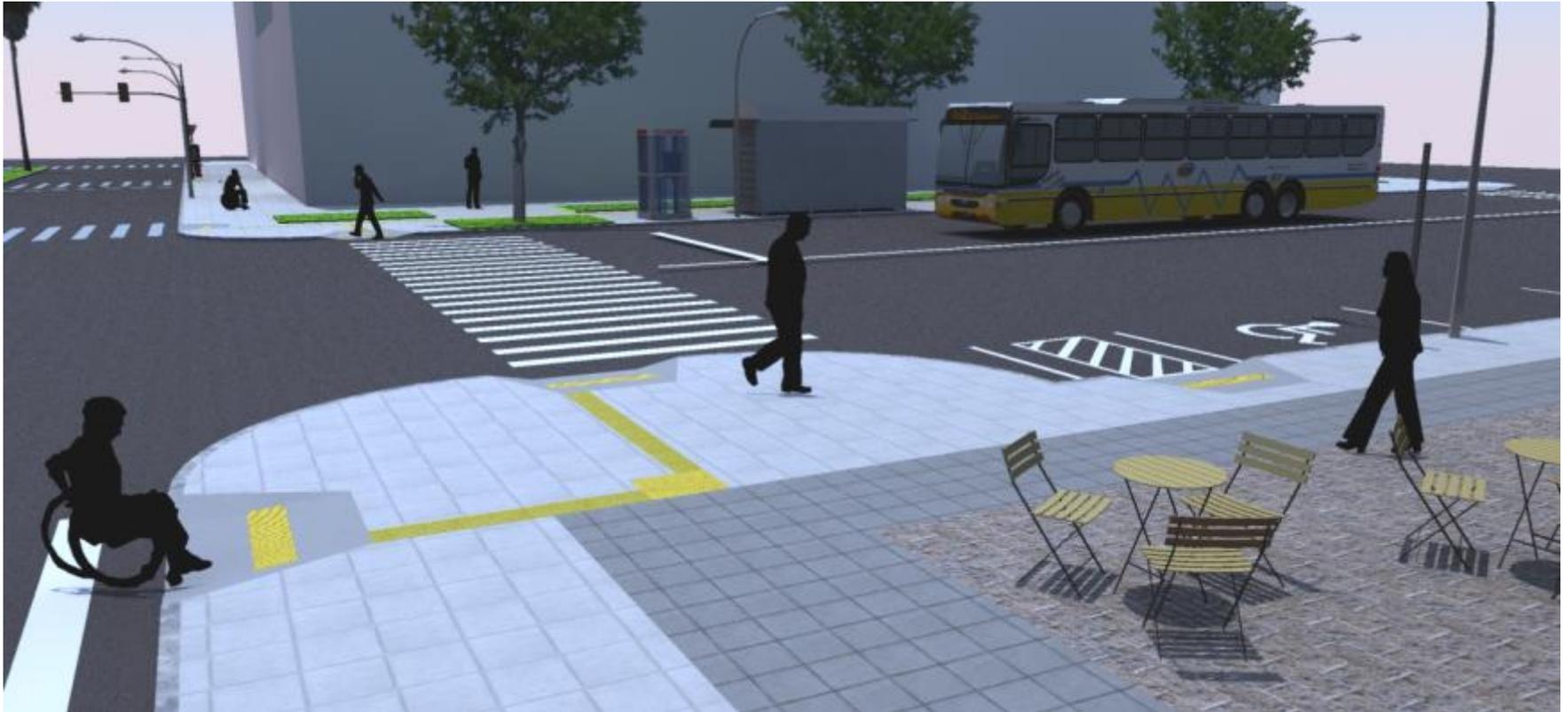
Calçada com três faixas e pavimentação diferenciada, com placas e blocos de concreto. Faixa de acesso e serviço com uso comercial.
