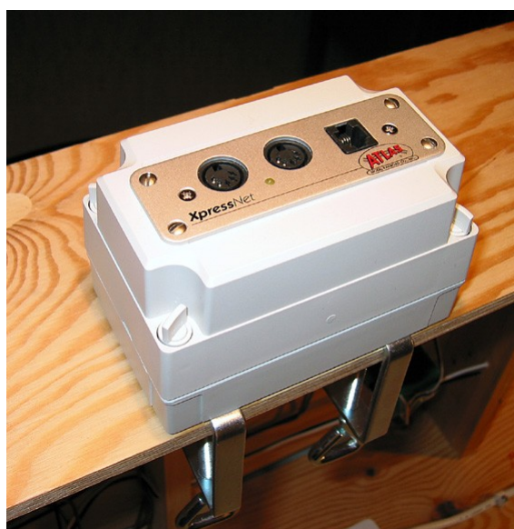
Bild 3. XpressNet anslutning (Atlas-panel)
