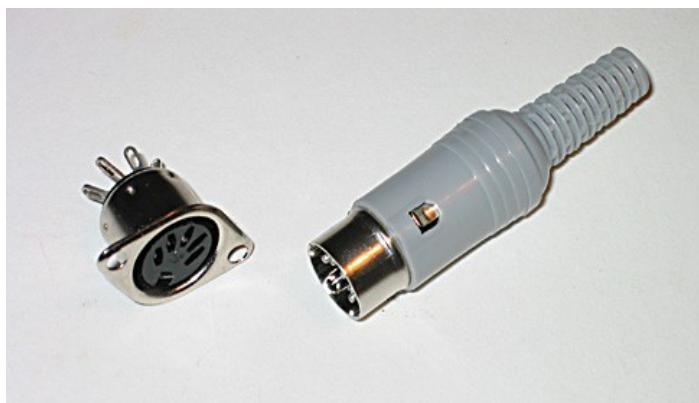
Bild 12. Chassie-hona och Sladd-hane. 5-pol DIN.
