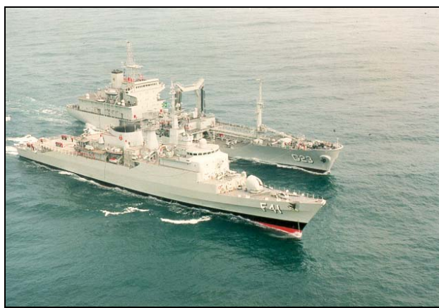
Figura 37 – Fragata Defensora (F-41) A/S em Faina de Reabastecimento de óleo com navio tanque (G-23)
