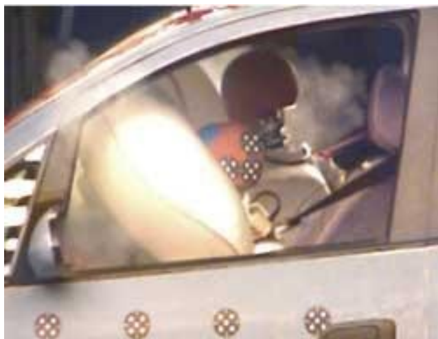
Fig 4.15 – Ação do Airbag
