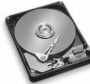
Fig. 1 – Interior de um disco duro
