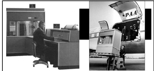
A IBM apresentou em 13 de setembro de 1956 o 305 RAMAC. O primeiro computador equipado com um disco rígido (HD) chamado IBM 350 Disk File. Era composto de uma pilha de 50 discos magnéticos de 24 polegadas que gravam a uma velocidade de 78 RPM e armazenavam 5 milhões de caracteres de 7 bits (4,4 MB). Só o disco pesava 1 ton.
