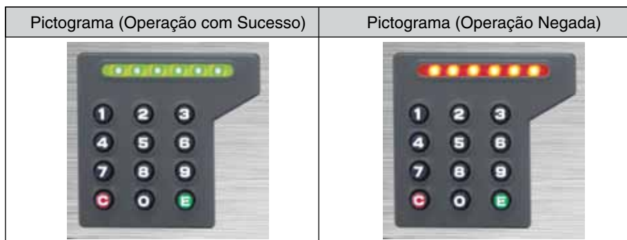
Figura 3 - Leds verde e vermelho
