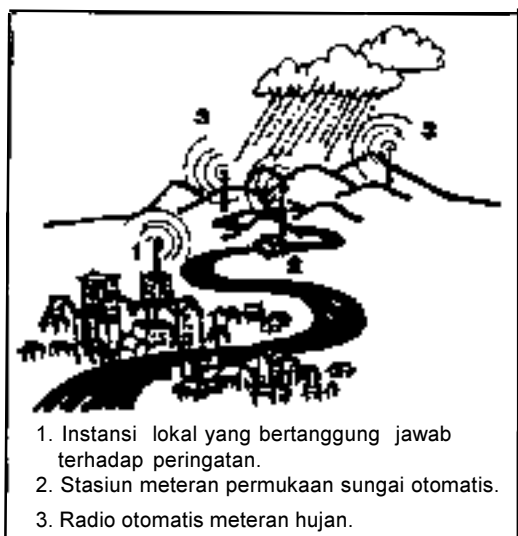
Skema gambar dari jaringan peringatan banjir berbasis radio.
