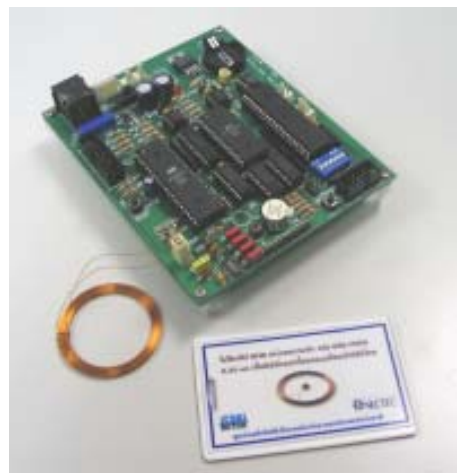
รูปที่ 15 บอร์ดเครื่องอ่าน RFID ย่านความถี่ต่ำ
