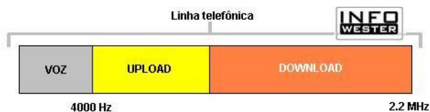
Figura 04 – Esquema demonstrativo de uma linha ADSL
