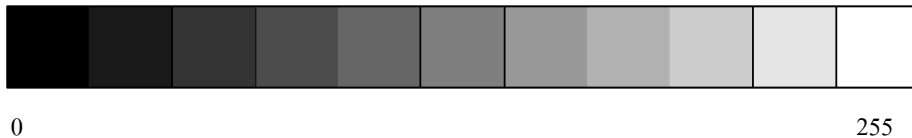
รูปที่ 1.2 : แสดงความเข้มแสงเทียบกับค่าที่ได้จากเซลล์รับภาพ
