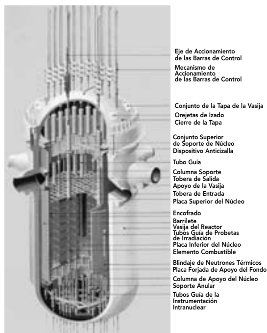
Figura 6. Vasija de un reactor PWR
