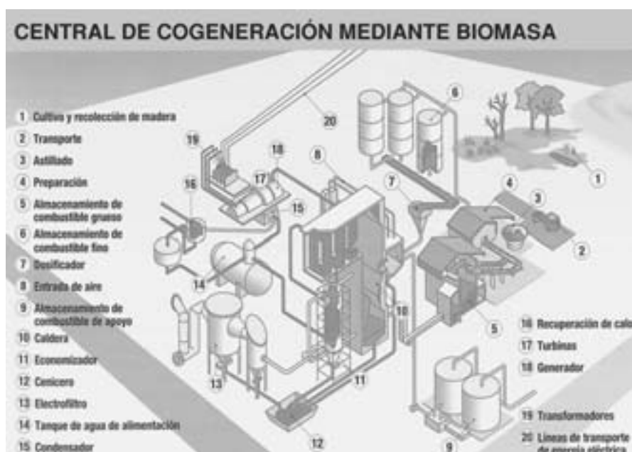
Figura 10. Esquema de aprovechamiento energético de la biomasa (Fuente: UNESA)
