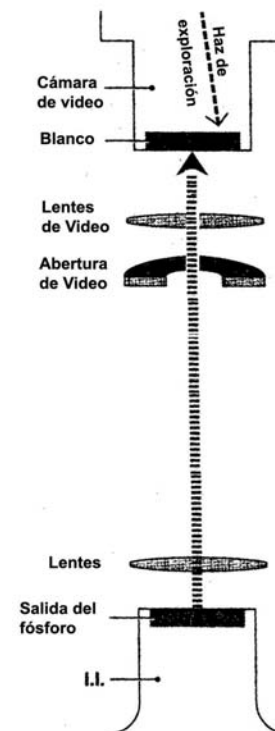
Esquema de la obtención de la imagen
