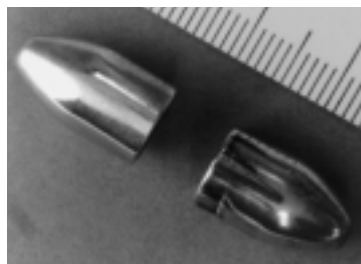
De oude volmantelkogel. Rechts verschoten met een Walther P5 (sporen van trekken en velden). Links verschoten met een Glock 17 (afgeronde hoeken van hexagonale loop). Foto: Marc Gravemaker.
