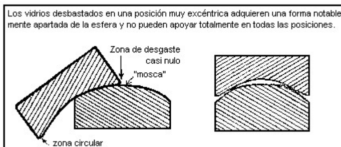
Fig 20. Deformación de los vidrios desbastados
