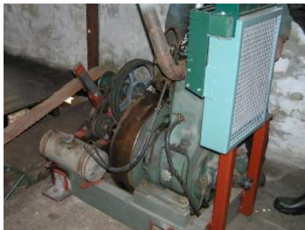
De dieselmotor, die het maalwerk aandrijft
