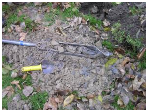
Boring met de edelmanboor: o.a. blauwe klei komt naar boven
