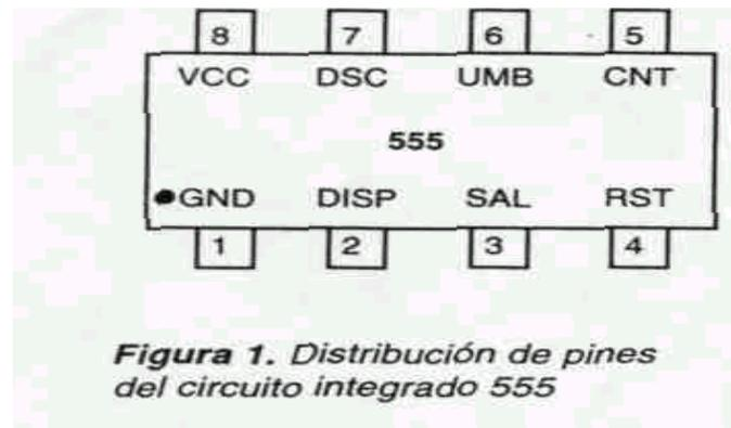
En la Figura 1 se muestra su distribución funcional de pines. Asociado con unos pocos componentes externos (resistencias y condensadores, principalmente) del circuito integrado 555 se puede utilizar para generar trenes de pulsos, temporizar eventos y otras aplicaciones, tanto análogas como digitales. Presenta básicamente tres modos de operación: el astable, el monoastable y como modulador.
