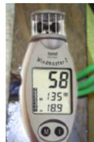
El anemómetro fue instalado a una altura de 6 metros (altura de buje) en el emplazamiento escogido anteriormente para el aerogenerador, esto con el fin de estimar y conocer los parámetros característicos del viento, que son el de forma K y de escala C de la ecuación de Weibull.
