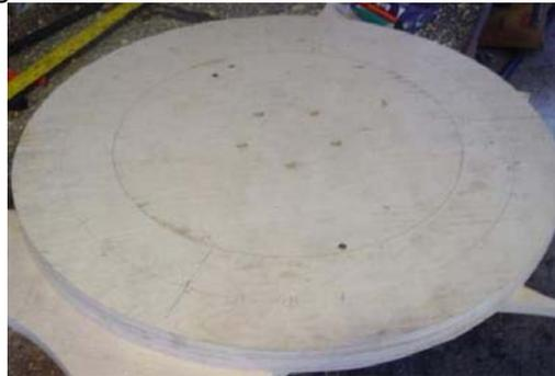
Los dos discos conteniendo las 3 palas ajustadas a ellos a  $120^\circ$  cada pala (ver Fig. 3.13), se ajustan directamente sobre los Clavos del Rotor que sobresalen por la parte frontal del rotor frontal.
