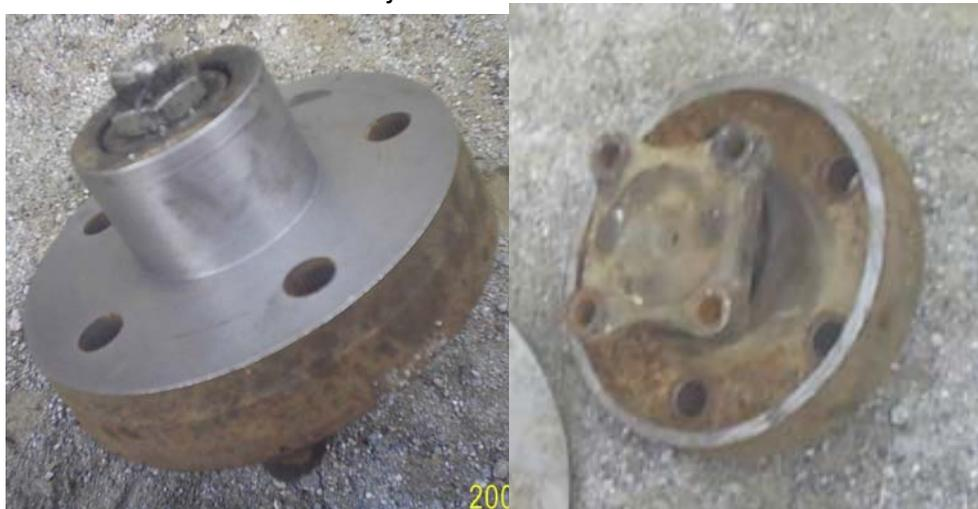
El buje encaja sobre el eje por medio de dos cojinetes cónicos que vienen ya incorporados, uno más grande en la parte inferior del eje y otro menor en la parte superior, que permiten el movimiento libre de giro del buje con los rotores incorporados sobre el eje.
