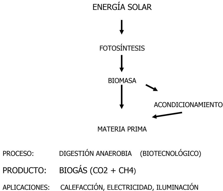
El denominado biogás es un biocombustible gaseoso que se obtiene en la digestión anaerobia (en ausencia del oxígeno) de la biomasa y cuyos principales componentes son el metano (55 – 65%), el dióxido de carbono (35 – 45%) y, en menor proporción, nitrógeno (0 – 3%), hidrógeno (0 – 1%), oxígeno (0 – 1%) y sulfuro de hidrógeno. Se produce a razón de unos 200 – 400 litros por kilogramo de materia seca, con un valor calórico de unas 5500 kcal/m<sup>3</sup> (depende del metano)
