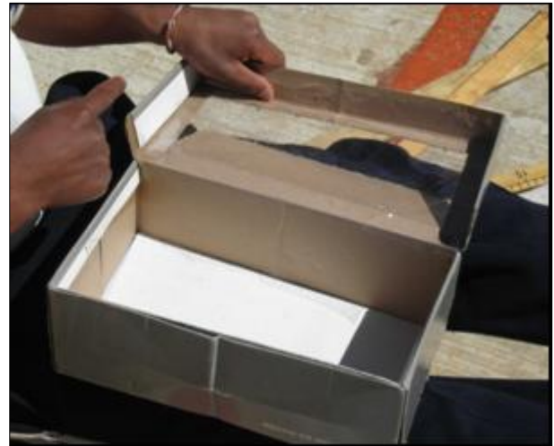
Figura 12: Horno solar al que se le está pegando el film de plástico transparente.
