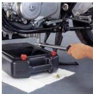
Figuur 8: Bouten vastdraaien
