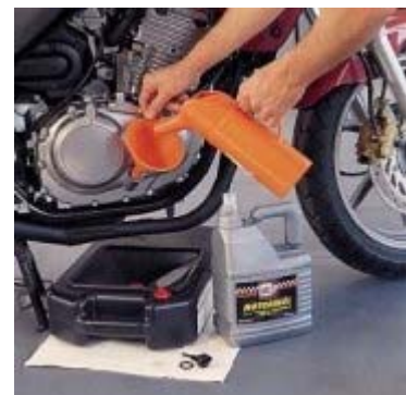
Figuur 9: Olie afvullen
