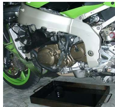
Figuur 2: olie uit laten lekken
