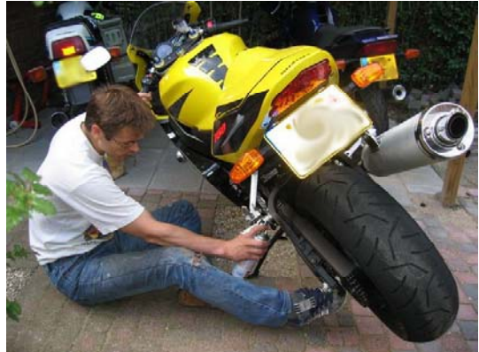
Figuur 12: Ketting smeren in je eentje
