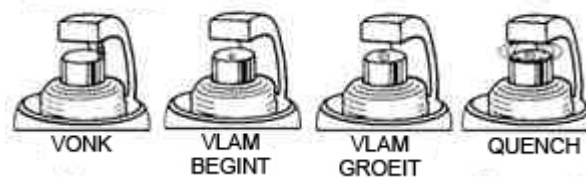
Figuur 3: het proces van quenchen
