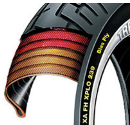
Figuur 3: Het karkas bevat belangrijke delen van de band. De meeste delen hoop je nooit te zien...
