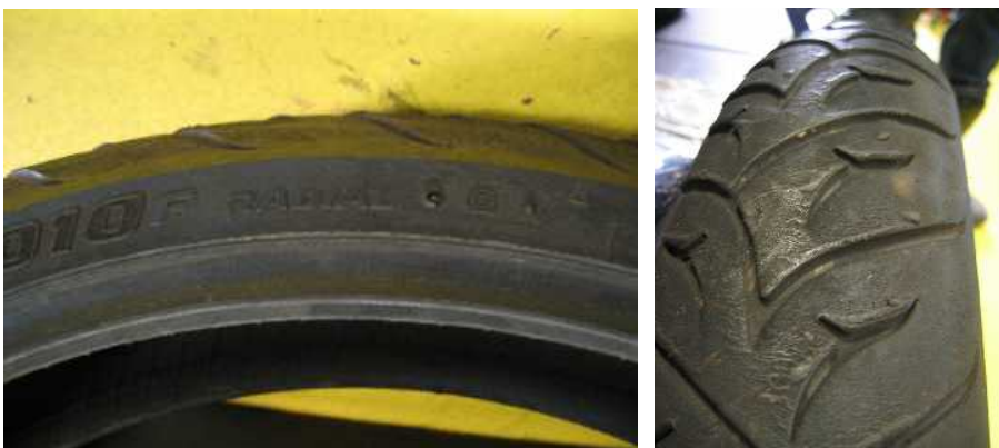
Figuur 10: "cupping", ofwel zaagtand op een BT010
