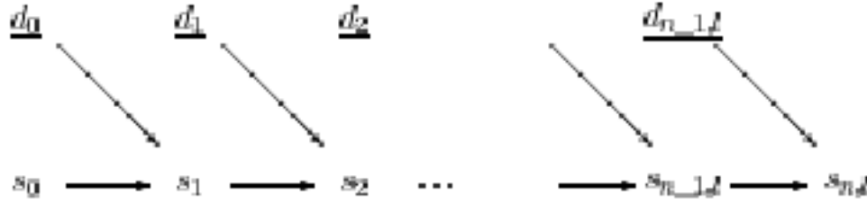
Gambar 3.5: Struktur dari transformasi balik wavelet: penggabungan rataaan dan selisih secara rekursif [19].
