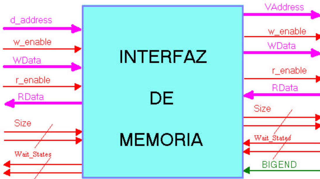
Figura 5-23: Interfaz de Memoria del CORE del ARM9
