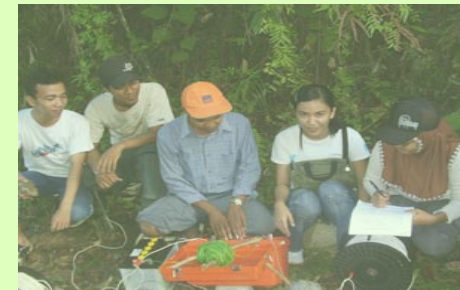
Gambar 3. Penelitian geotermal di Air Putih, Kab. Lebong, Prov. Bengkulu dengan Metode Geolistrik Tahanan Jenis
