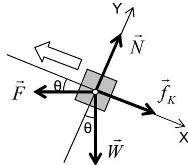
El modelo matemático de la fuerza de rozamiento cinético contiene la reacción normal,  $\vec{N}$ , así que evaluamos el principio de inercia para la dirección Y para obtenerla.
