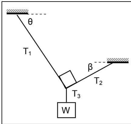
En el punto de unión de las tres cuerdas colocamos el origen del sistema de coordenadas. Descomponemos las fuerzas y planteamos la condición de equilibrio de traslación.
