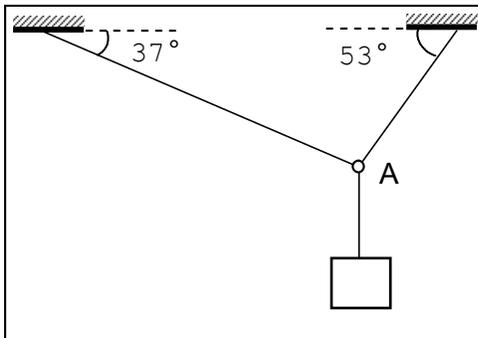
Por cada uno de los tres segmentos de cuerda tenemos una tensión. Las tres tensiones concurren en el punto A; ahí colocamos el origen del sistema de coordenadas, para hacer el diagrama vectorial y descomponer las fuerzas oblicuas.
