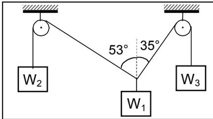
Las tensiones en los segmentos de cuerda que pasan por las poleas son numéricamente iguales a los pesos de los cuerpos suspendidos; esto por el hecho que consideramos despreciable la masa de las cuerdas y despreciable el rozamiento de ellas con las poleas.
