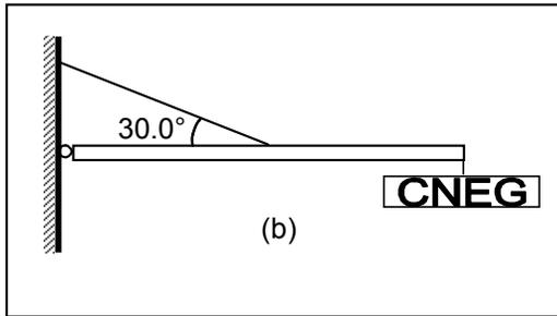
En el diagrama del cuerpo libre tenemos dos reacciones que ejerce el pivote sobre la barra. El centro de gravedad de la barra homogénea está en su centro geométrico.
