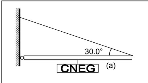
En el diagrama del cuerpo libre tenemos dos reacciones que ejerce el pivote sobre la barra. El peso de la barra lo ubicamos en el centro de gravedad.
