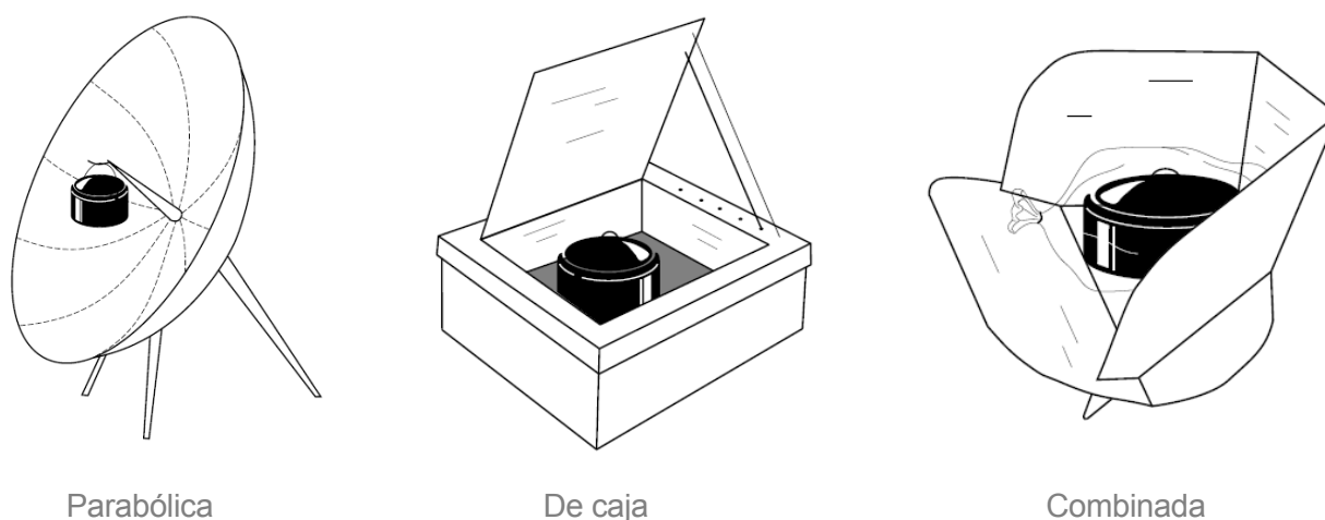
Ilustración 12. Clasificación de los diferentes tipos de cocinas solares según la forma en que la olla recibe la energía [18]
