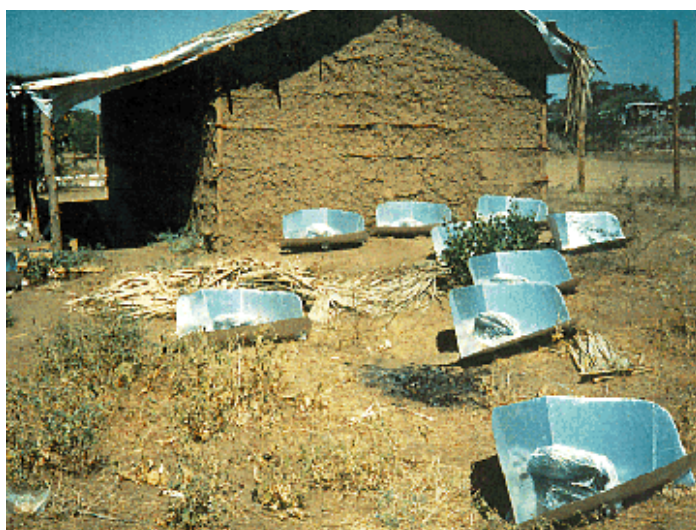
8. Varias Cocinas tipo panel en Eritrea
