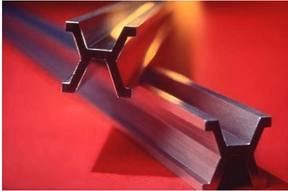
Figura 6. Patrón secundario del metro patrón (distancia entre dos marcas en la superficie de la barra de platino-iridio).
