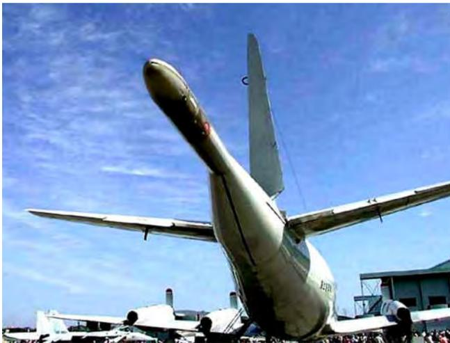
Figura 6.14. Botalón con el magnetómetro en su interior
