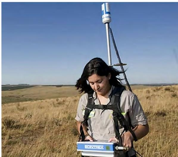
Figura 6.10. Prospección de minerales ferrosos. El magnetómetro se encuentra en el extremo de la pértiga.
