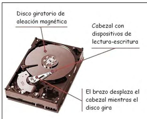
Figura 2.13. Figura 02-13. Disco duro (HDD). Los más recientes poseen 4 o más brazos móviles. Tomado de <http://www.taringa.net/posts/info/2392240/Ensamblaje-de-pc.html>
