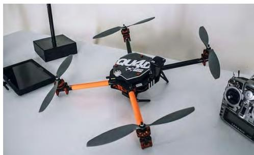
Figura 6.12. Drone utilizado en la actualidad en la prospección de minerales por medios no magnéticos, con una autonomía de vuelo de 15 a 20 minutos.
