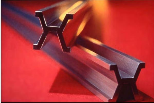
Figura 2.14. Patrones secundarios del metro patrón primario (distancia entre dos marcas en la superficie de la barra).
