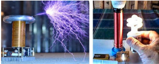
Figura 6.19. Izq. Ionización del aire a causa del alto voltaje. Der. Minibobina Tesla iluminando a distancia una lámpara fluorescente compacta (LFC).
