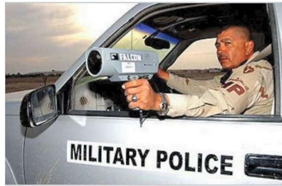
Figura 5.30. Radar Doppler. El instrumento calcula la rapidez del auto infractor comparando las frecuencias del haz emitido y del haz reflejado, que son diferentes en virtud del efecto Doppler.
