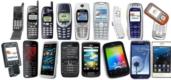
Figura 5.19b. Evolución de los teléfonos celulares. A partir de determinado momento, la antena emisora-receptora quedó oculta en el interior del celular (antena fractal), las pantallas se volvieron táctiles, se añadió una cámara fotográfica, etc.
