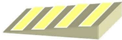
Figura 3.18. Franjas de interferencia en lámina de espesor variable.
