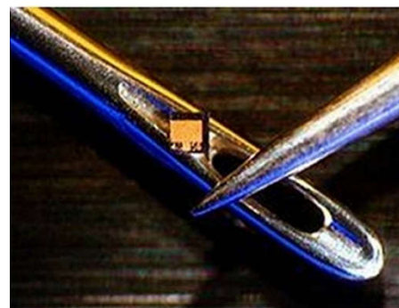
Figura 3.14. Arr. Diferencia entre un diodo emisor de luz convencional (LED) y un diodo láser. Ab. Tamaño típico de un diodo láser (cuadrado amarillo).
