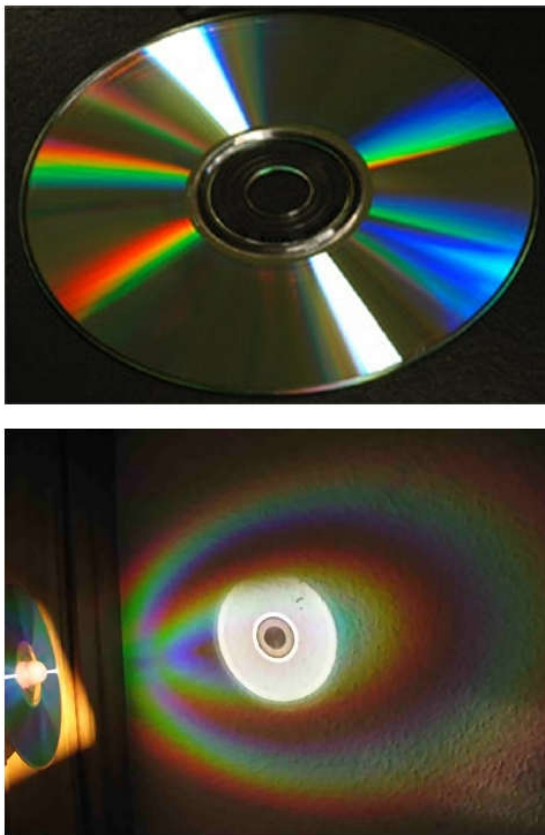
Figura 4.12. Patrón de difracción de la luz reflejada en un CD.
