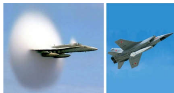
Figura 8.31. Izq. Rompiendo la barrera del sonido en un FA18 Hornet. Cada parte saliente del avión genera su propia onda de choque. Der. Misil hipersónico “Daga” ( Kinzhal ) cargado por un Mig-31K.
