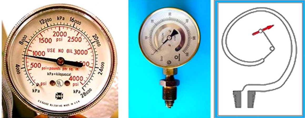
Figura 7.13. Izq. Manómetro aneroide; funciona similar al barómetro aneroide. Der. Manómetro de Bourdon. Usa un tubo enrollado en espiral acoplado a la aguja.
