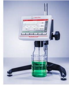
Figura 7.28. Análisis de la velocidad del líquido. A la derecha, viscosímetro de rotación comercial.
