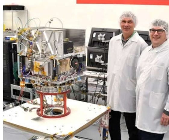
Figura 1.3. Un reloj atómico moderno como el que está sobre la mesa no varía más de 1 s en 200 000 años. (Tomado de https://www.meteorologiaenred.com/reloj-atómico.html )
