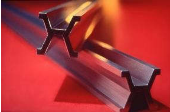
Figura 1.15. Patrones secundarios del metro patrón primario (distancia entre dos marcas en la superficie de la barra).
