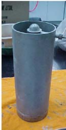
Figura II-5 - Equipamento do ensaio de "dropping ball" (SILVA et al., 2005).
