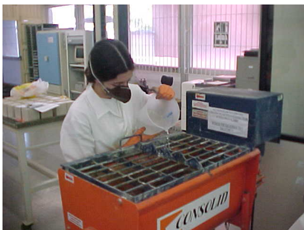
Figura II-21 - Adição de água para obtenção da consistência desejada para a argamassa.
