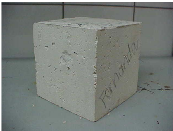
Figura II-28 - Corpo de prova cúbico com vazios, moldado no dia 20/10.
