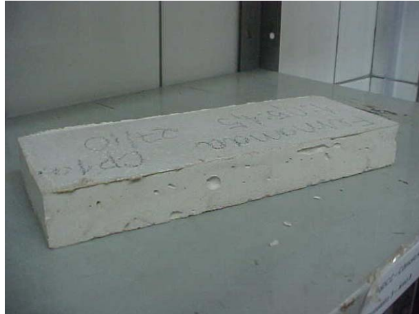
Figura IV-1 - corpo de prova em forma de placa, apresentando vários vazios em sua face lateral (moldado em 27/10).
