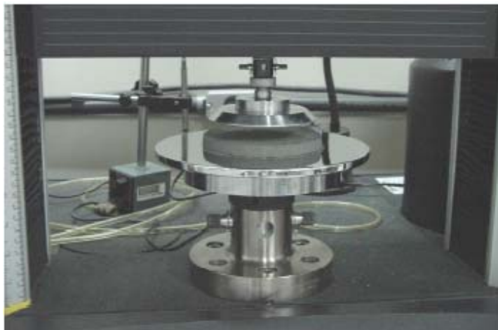
Figura II-6 - Equipamento para realização do ensaio de "Squeeze Flow" (SILVA et al., 2005).
