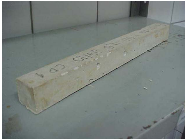
Figura IV-1 - corpo de prova em forma de placa, apresentando vários vazios em sua face lateral (moldado em 27/10).
