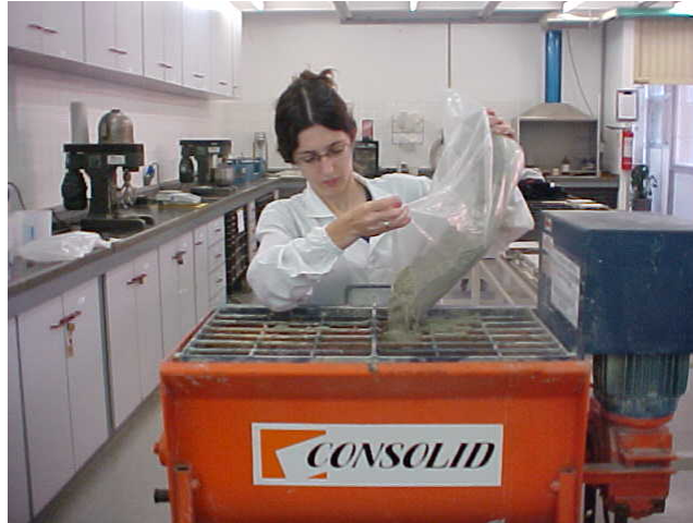
Figura II-22 - Adição de cimento à mistura de cal, areia e água, para produção de argamassa.
