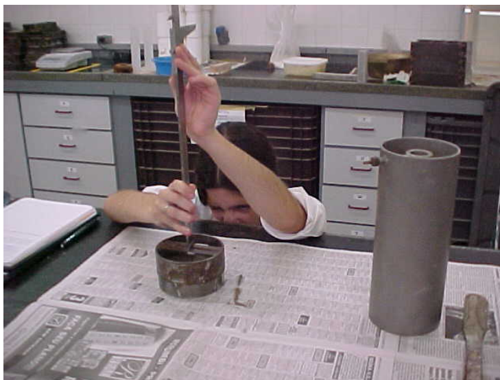
Figura II-17 - Realização do ensaio de "dropping ball", no dia 26/10.
