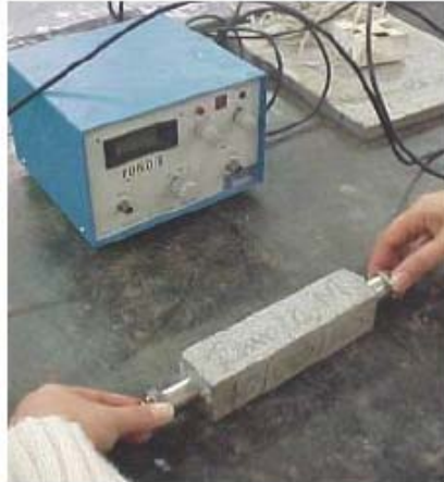
Figura II-14 - Foto da realização do ensaio do módulo de deformação por ultrassom, com o equipamento PUNDIT (MONTE et al., 2005).
