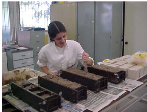
Figura II-22 - Adição de cimento à mistura de cal, areia e água, para produção de argamassa.
