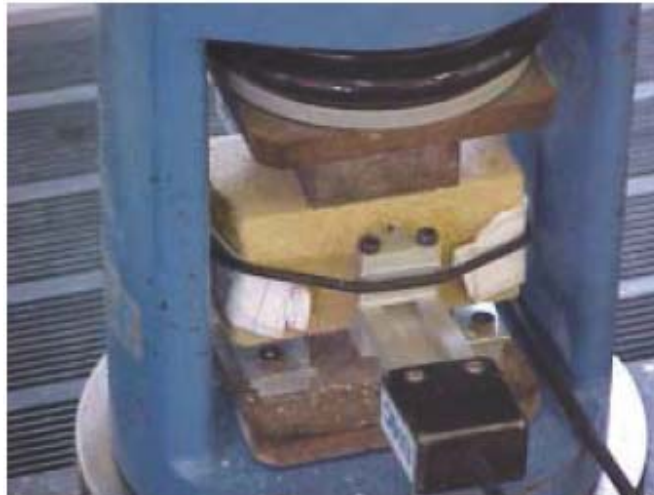
Figura II-10 - Exemplo de ensaio de determinação do módulo de deformação à compressão (CRESCENCIO, 2003).
