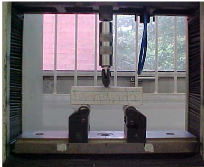
Figura III-4 - Ensaio de resistência à tração na flexão do corpo-de-prova prismático (EMIC). (As linhas contínuas que aparecem no corpo de prova referem-se à posição em que os extensômetros serão acoplados durante o ensaio do módulo de deformação)
