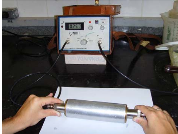
Figura B - 1 - Calibração do equipamento de ultrassom, com tempo de propagação da onda esperado indicado (25,7 \mu s).
