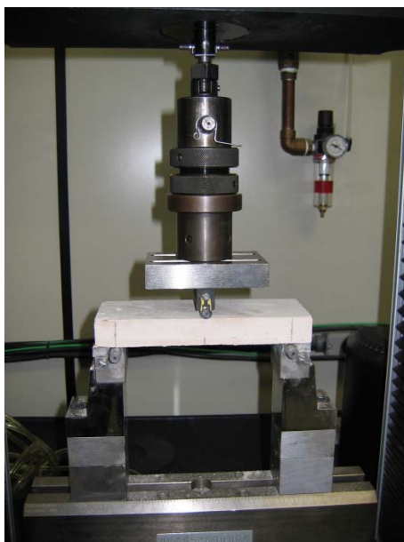
Figura III-5 - Ensaio de resistência à tração na flexão do corpo-de-prova em forma de placa (INSTRON).
