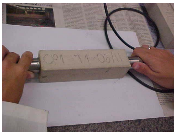
Figura III-11 - Realização do ensaio de ultrassom no corpo-de-prova prismático.
