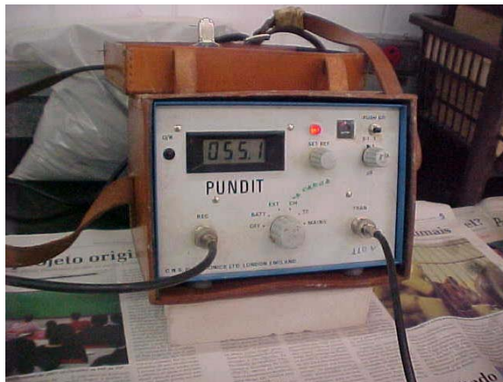
Figura III-10 - Equipamento do ensaio de ultrassom (PUNDIT).
