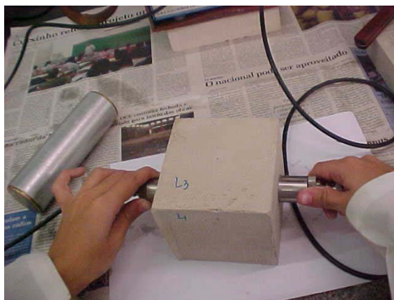
Figura III-12 - Realização do ensaio de ultrassom no corpo-de-prova cúbico. À esquerda, encontra-se a barra de calibração (explicações detalhadas no ANEXO B).
