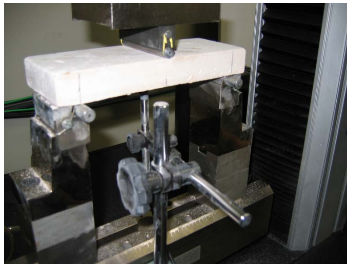
Figura III-9 - Ensaio de módulo de deformação à tração na flexão. A deformação é medida através de um LVDT acoplado a uma base magnética.
