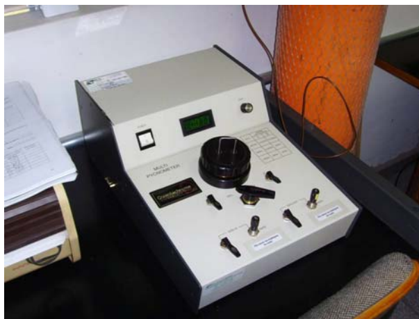
Figura B - 5 - Picnômetro de gás Hélio.
