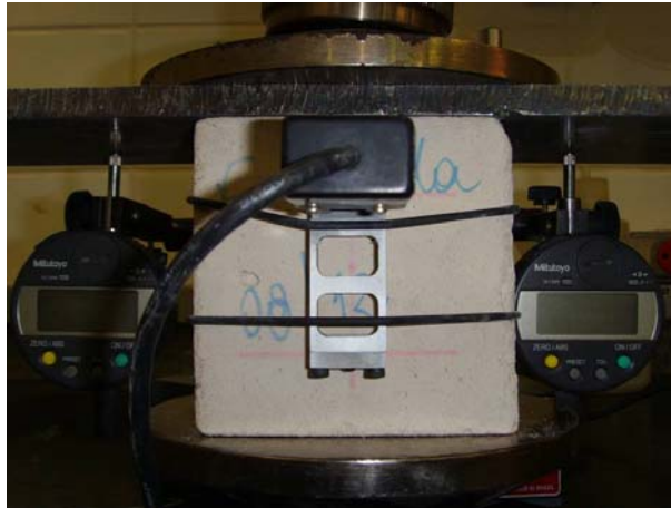
Figura III-8 - Montagem do ensaio de módulo de deformação à compressão para o cubo, com os extensômetros de 50mm acoplados e os relógios comparadores posicionados.
