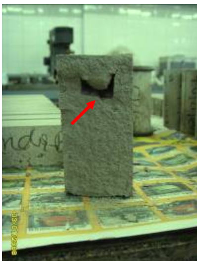
Figura 2.6 - Corpo-de-prova após ensaio de resistência à tração por compressão diametral. Nota-se o molde do soquete no vazio presente (argamassa polimérica)
