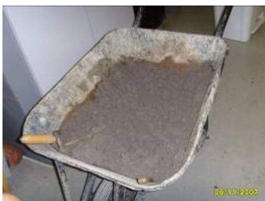
Figura 2.2 - Argamassa com polímero (moldagem descartada) com consistência seca, assemelhando-se a uma argamassa de contrapiso.
