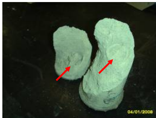
Figura 2.7 - Corpo-de-prova após ruptura à compressão. Novamente, há um defeito em forma de vazio deixado pelo soquete (argamassa polimérica).
