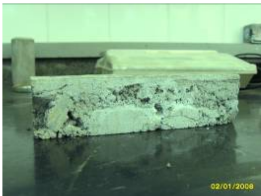
Figura 2.4 - Corpo-de-prova prismático, argamassa Baucryl 60/80 T1, com grande quantidade de defeitos.
