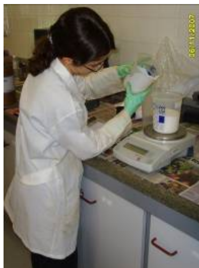
Figura 2.11 - Pesagem da quantidade de látex necessária.
