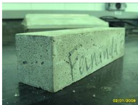
Figura 2.23 - CP da argamassa Baucryl 60/80 T2. A quantidade de defeitos é pequena, e as bolhas indicam incorporação de ar.
