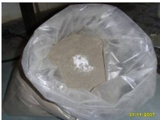
Figura 2.10 - Incorporador de ar e cimento antes de serem misturados, por agitação manual no saco plástico.
