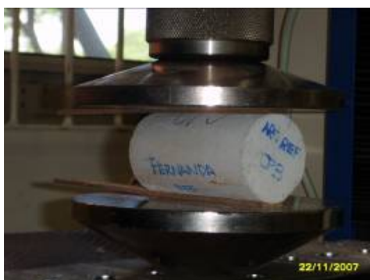
Figura 2.13 - Ensaio de resistência à tração por compressão diametral.
