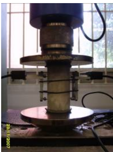
Figura 2.17 - Ensaio de módulo à compressão - cilindro.
