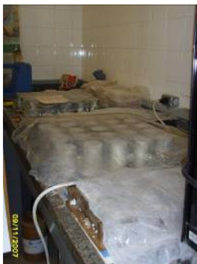
Figura 2.12 - Corpos-de-prova cilíndricos, cobertos com plástico, mantidos em ambiente de laboratório.
