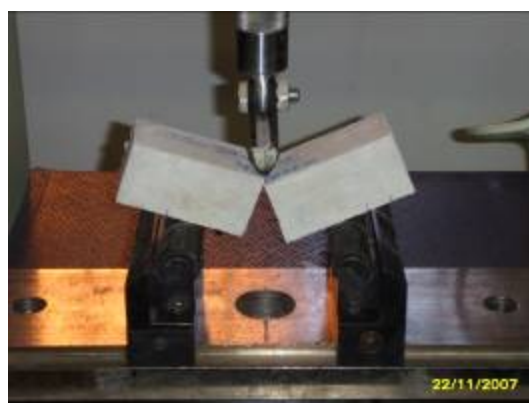
Figura 2.14 - Ensaio de resistência à tração na flexão.
