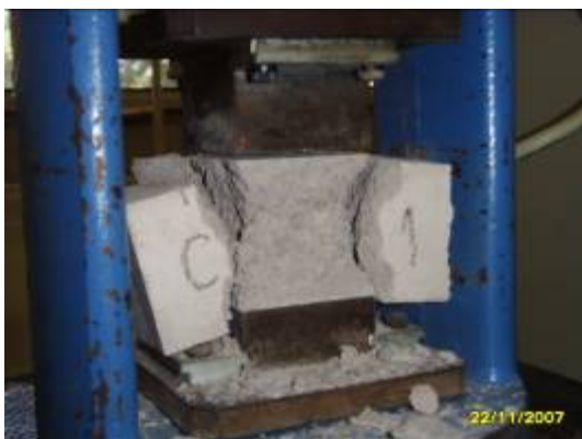
Figura 2.15 - Ensaio de resistência à compressão - prisma.
