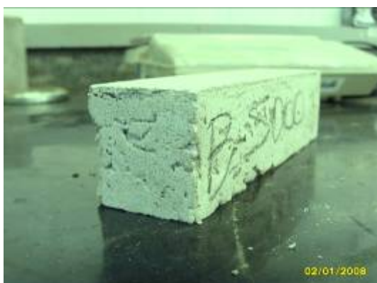
Figura 2.22 - CP da argamassa Baucryl 5000, com grande quantidade de defeitos.
