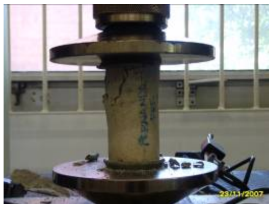
Figura 2.16 - Ensaio de resistência à compressão - cilindro.
