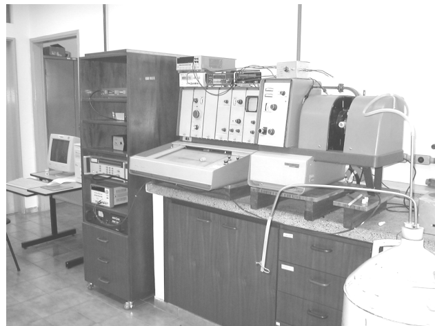
Figura 4.7: Foto do aparato experimental para medidas de RPE e RMDE.
