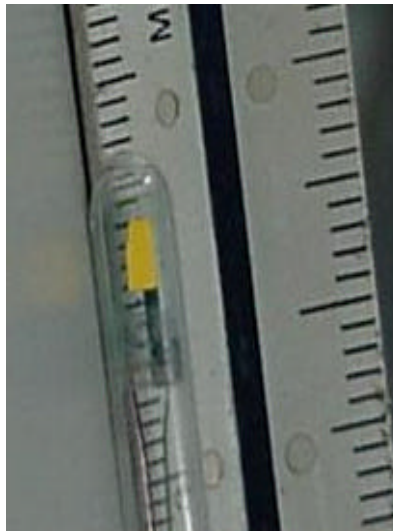
Figura 4.8: Foto de um dispositivo encapsulado para medida de RMDE, escala em milímetros.
