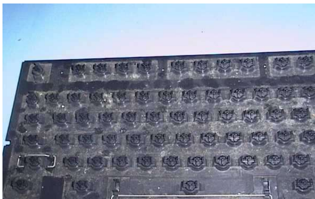
Figura 36 - Sujeira no interior de um teclado, depois de retiradas as teclas.
