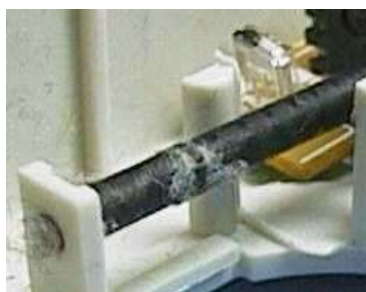
Figura 33 - Roletes do mouse. Observe a sujeira acumulada nos pontos indicados. Veja no detalhe abaixo, quanta sujeira no rolete!
