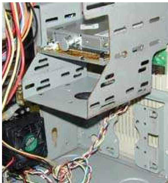
Figura 5: Local para a instalação de uma segunda ventoinha (parte frontal do gabinete).
