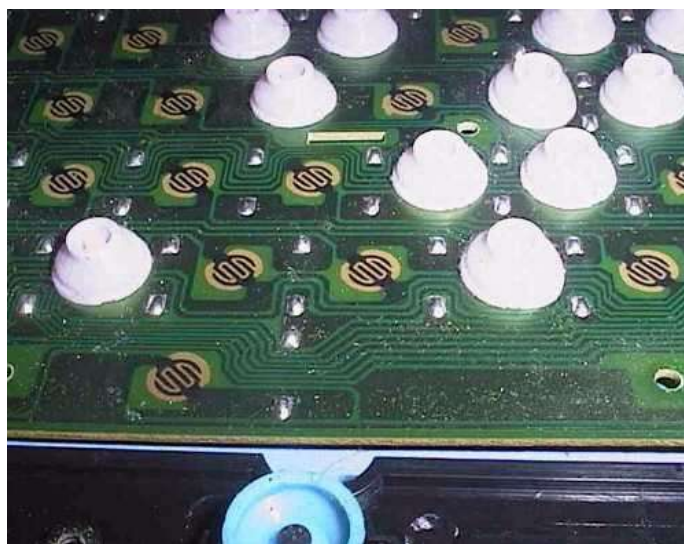
Figura 37 - Limpando uma cápsula com spray.
