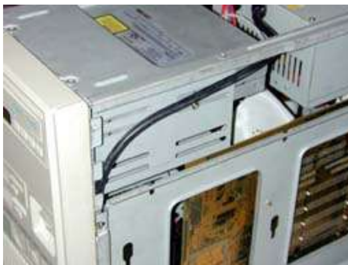
Figura 8: Forma correta de se passar o cabo da chave liga-desliga em gabinetes AT.
