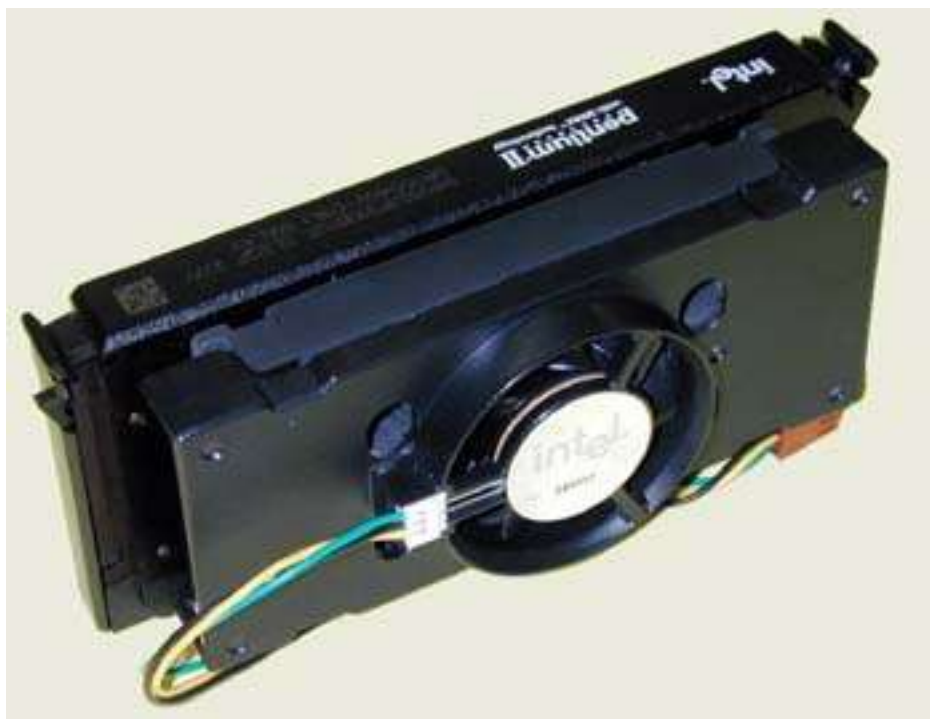
Figura 2: No processador Pentium II in-a-box a ventoinha já vem integrada ao corpo do processador.
