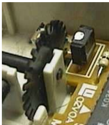
Figura 34 - Rodas dentadas e sensores óticos de um mouse. A seta indica um dos sensores. No detalhe abaixo vemos de um lado da roda um emissor, do outro o sensor.
