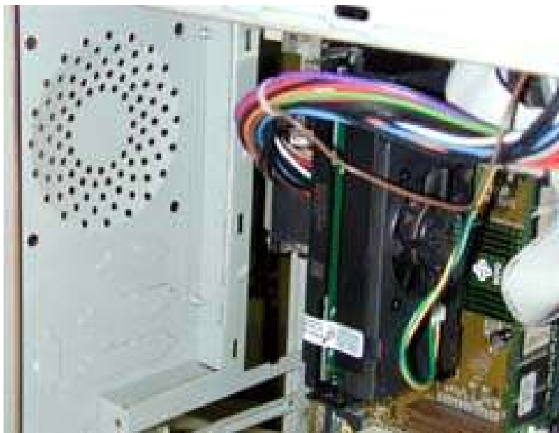
Figura 6: Outro local para a instalação de uma segunda ventoinha (parte traseira do gabinete).
