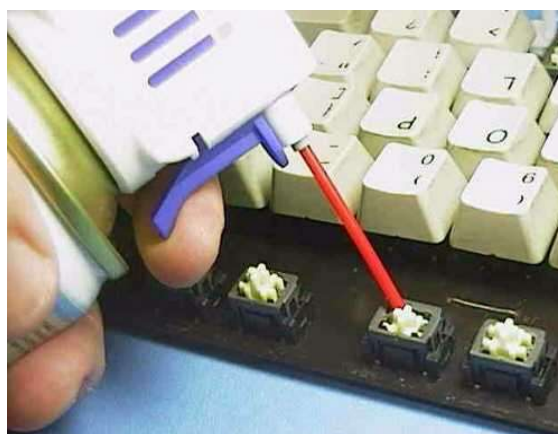
Figura 41 - Aplicando spray no interior de uma cápsula.
