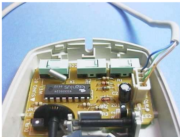
Figura 35 - O botão do meio pode ser colocado no lugar de um botão defeituoso.
