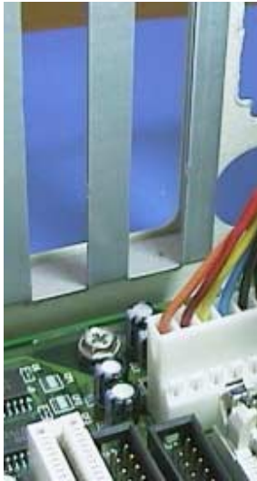
Figura 4.11 - Conectando a fonte de alimentação AT na placa de CPU.
