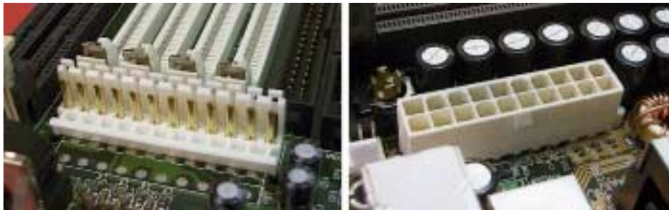
Figura 1.5 Conectores de fonte padrão AT e ATX
