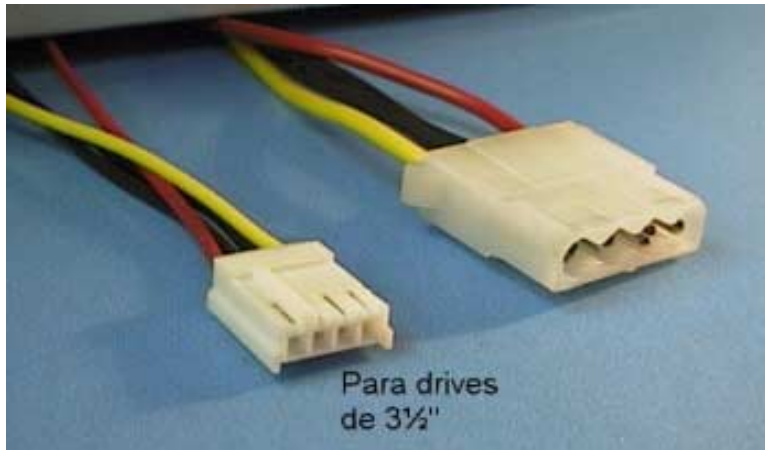
Figura 1.25 Conectores para alimentar drivers de disquetes, discos rígidos e drivers de CD-ROM.
