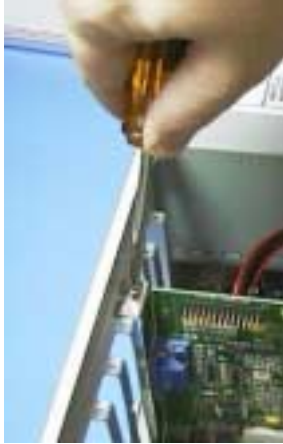
Figura 4.17 - Aparafusando a placa SVGA no gabinete.
