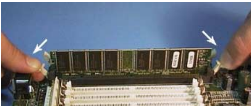
Figura 2.9 Removendo um módulo DIMM/168.
