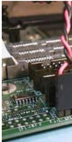
Figura 2.11 Conexão para o PC Speaker.
