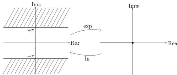
Fig. Gauche : exemple de domaine restreint de définition de l'exponentielle assurant son injectivité. Droite: domaine image par l'exponentielle, sur lequel est définie la détermination principale de la fonction logarithme.
