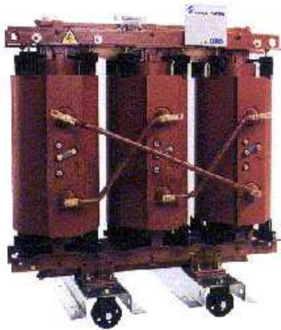
Se puede decir que un transformador trifásico está constituido por tres transformadores monofásicos montados en un núcleo magnético común. La constitución más común es la de tres columnas, con los arrollamientos primarios y secundarios alternados o concéntricos.
