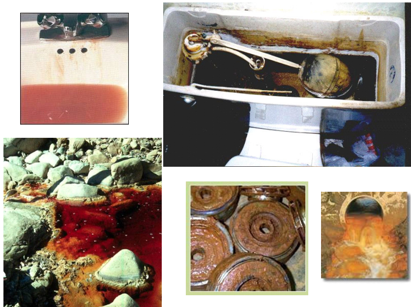
Figura 1: Problemas de calidad de agua por exceso de hierro en el agua potable
