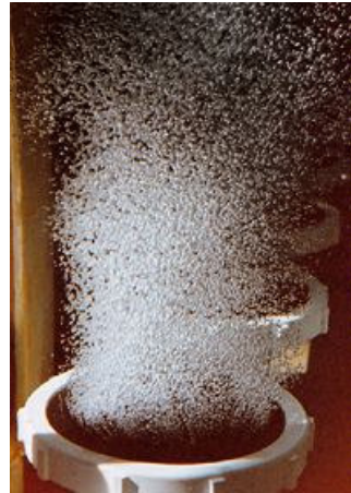
Figura 4: Equipo industrial para producción de ozono y difusores de burbuja fina para inyección del aire rico en ozono.
