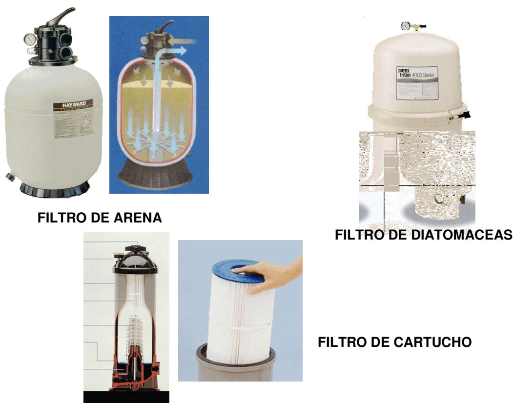
Figura 4: Tipos de filtros que se pueden emplear en albercas. Filtro de arena, de cartucho y de tierras diatomáceas.
