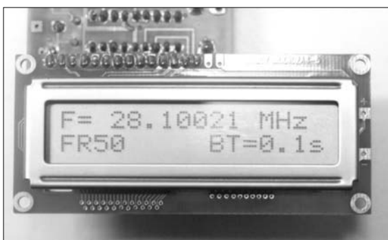
La pantalla del frecuencímetro mostrando información de la frecuencia leída con una resolución de 10 Hz y el tiempo de puerta.
